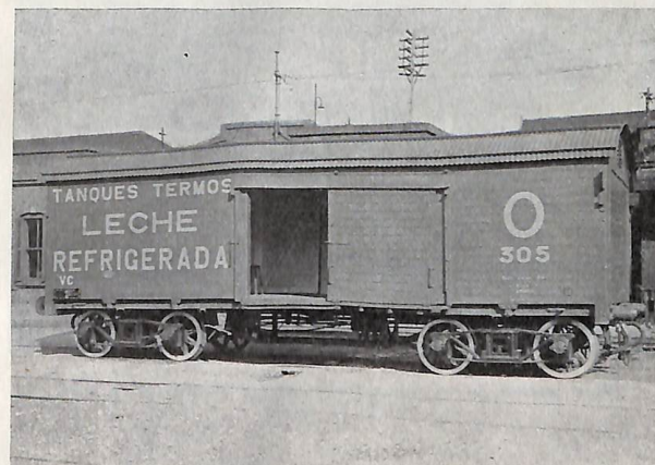
Vista exterior de un vagón-tanque para transporte de leche del F. C. Oeste.
